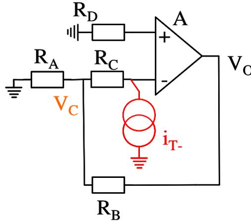
In questo caso il terminale non-invertente non può che essere a potenziale nullo. Per effetto della reazione anche il terminale invertente sarà ad un potenziale simile. La corrente  $i_{T-}$  sviluppa ai capi di  $R_C$  una ddp che si sottrae (o somma) al valore del potenziale non-invertente, ovvero nullo. Quindi si ha che l'equazione al nodo avente potenziale  $V_A$  è:
